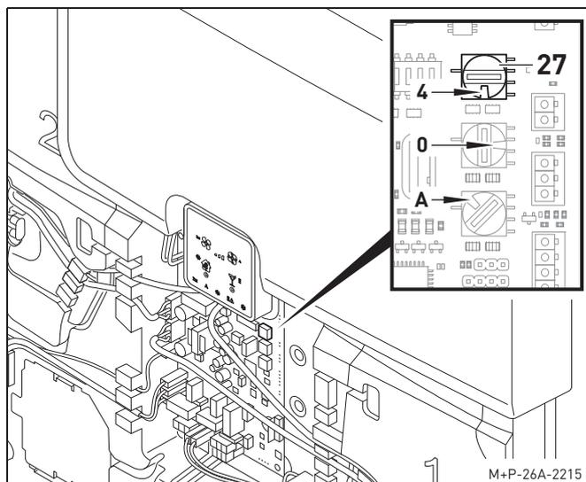
8. Conformemente ai dati di progetto, la portata d'aria nominale (estrazione) può essere modulata, sulla base delle curve pV, utilizzando il commutatore di regolazione (27) (vedi i diagrammi alle pagine successive).
