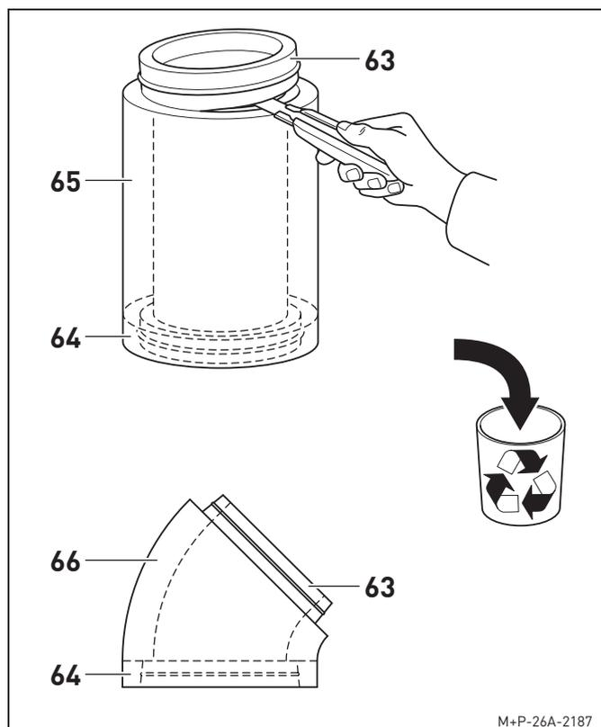
1. In base alla sequenza di montaggio dei condotti, tagliare e smaltire il nipple (63) o il manicotto (64) dei condotti preisolati IsoPlugg (65) o delle curve IsoPlugg (66).
