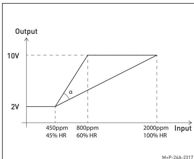
$\alpha$  Rampa impostabile mediante potenziometro P1
