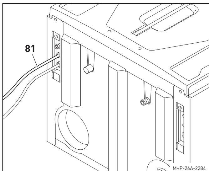
7. Inserire il cavo (81) dei componenti da collegare (rilevatore di fumo, pressostato, ecc.) nell'apparecchio per la ventilazione residenziale facendolo passare per il passacavo.
