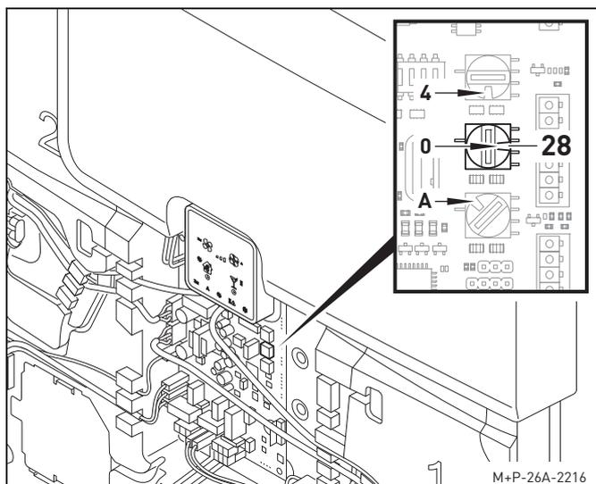
Impostare il rapporto necessario mediante il commutatore di regolazione (28) (impostazione di fabbrica: posizione 0 = stesso numero di giri dei ventilatori).
