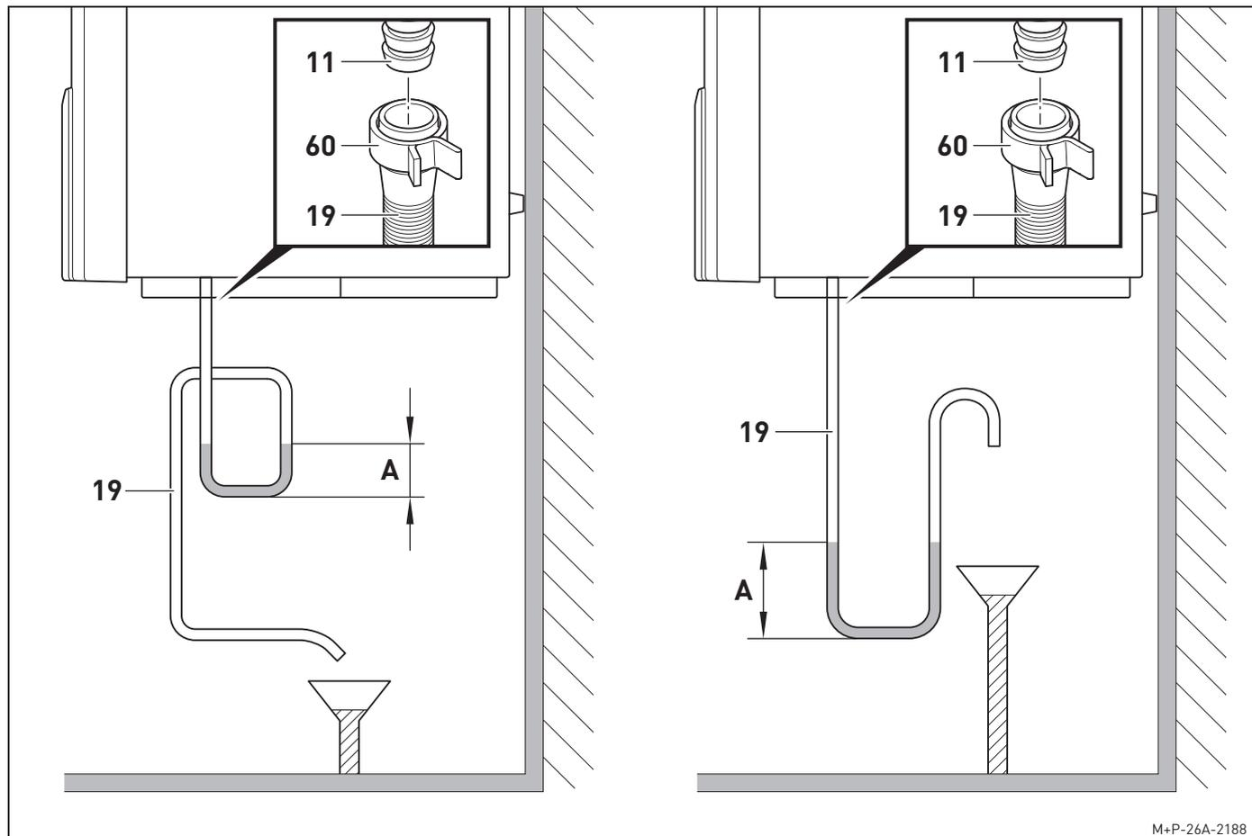
1. Utilizzando la fascetta (60) fornita con l'apparecchio, fissare il condotto di scarico condensa (19) sul lato dell'attacco DN19 allo scarico condensa (11) e farlo scendere in uno scarico o un sifone come indicato in figura.
