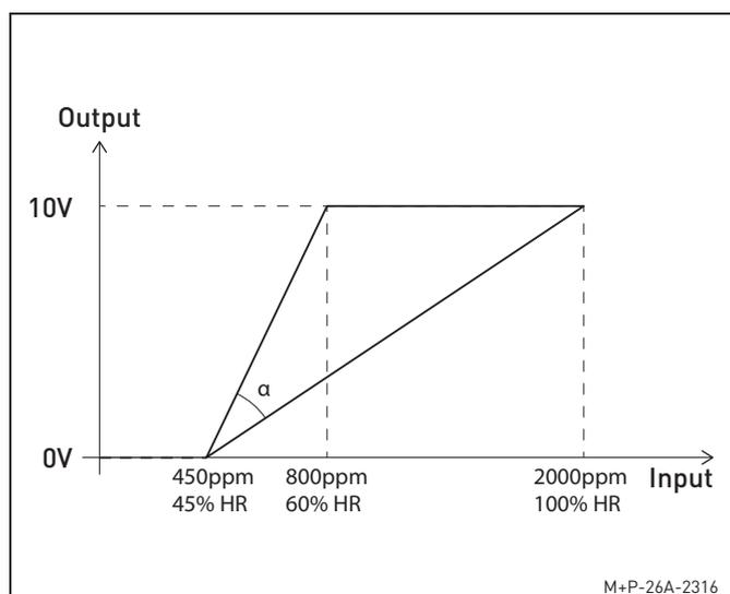
$\alpha$  Rampa impostabile mediante potenziometro P1
