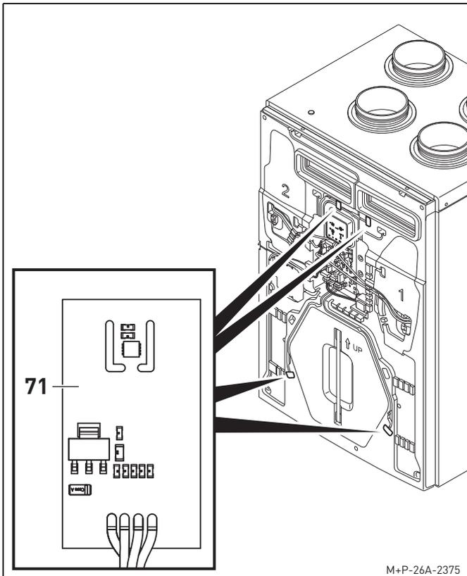
6. Togliere il sensore di umidità/la sonda di temperatura (71) (incluso il cavo) dall'apparecchio per la ventilazione residenziale.
