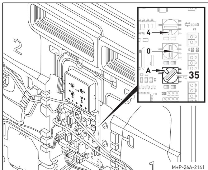
7. Mettere il commutatore di regolazione (35) sulla posizione che corrisponde al valore da impostare per l'umidità in fase di estrazione (vedi la tabella seguente - Impostazione di fabbrica: posizione A).
