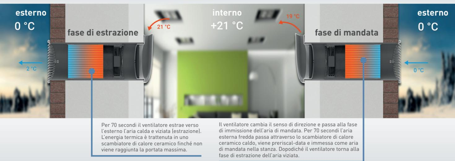
Un sistema di ventilazione residenziale, oltre ad avere dei vantaggi dal punto di vista energetico, previene in modo efficiente un'eccessiva concentrazione di umidità e la formazione di muffa, garantendo così delle condizioni più salubri all'interno dell'abitazione e aumentando il valore del proprio immobile a lungo termine.
